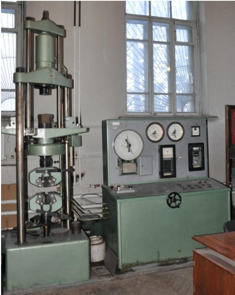
30-тонна універсальна машина типу «ЦДМУ-30т», аудиторія 176
