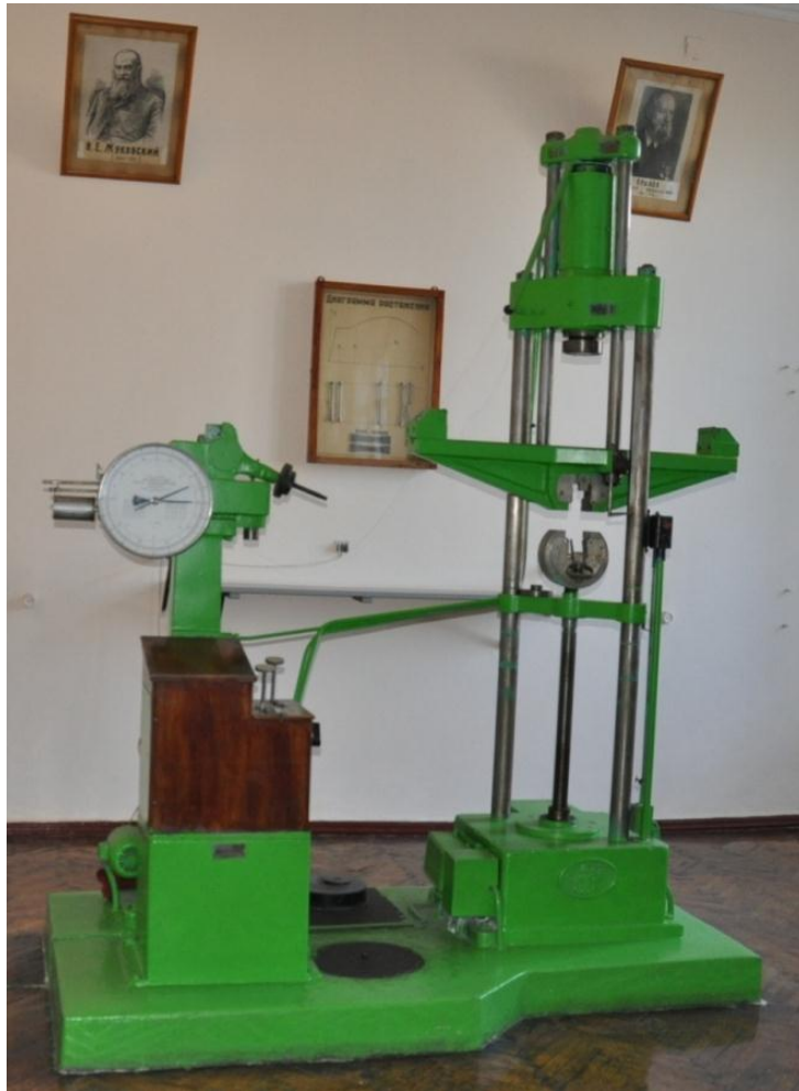
Універсальна гідравлічна машина УГ20/2 (випробування зразків на розтягання/стискання та згин) , аудиторія 170
