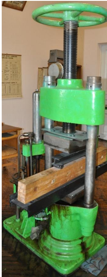
Стенд для випробувань дерев'яної балки, аудиторія 168
