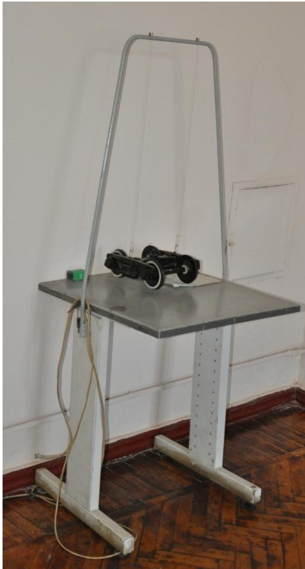
Стенд для визначення величини моменту інерції твердого тіла, аудиторія 170
